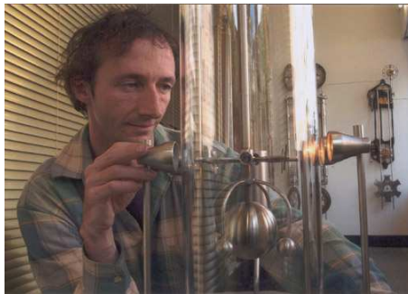
Fig. 3: Pendule entretenu par effet lumineux. Le pendule dont nous analysons les mesures de période fonctionne sur le principe du radiomètre de Crookes. Il est contenu dans un enceinte où la pression est de l'ordre de 1/100 de la pression atmosphérique. De façon à minimiser les frottements il est posé sur des couteaux d'horlogerie ce qui lui permet d'osciller durant 6 heures après avoir été déplacé de 2 cm. Les battements du pendule sont comptés par un dispositif optique à chaque fois que le bras coupe un rayon infrarouge.
